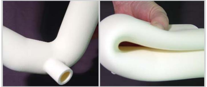
*Ci-dessus* : Prototypé de durite de radiateur pouvant être plié sans subir de dommages, ni de déformation permanente (sans infiltrant).
