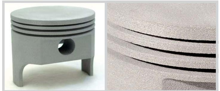
*A gauche* : L'apparence métallique gris clair simule les pièces en aluminium moulé.
