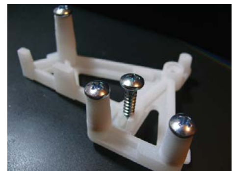
Les vis autotaraudeuses peuvent être utilisées avec le plastique DuraForm® PP100.
